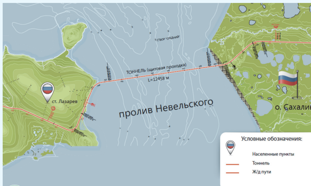
Рис. 6. Тоннельный вариант перехода через пролив Невельского
